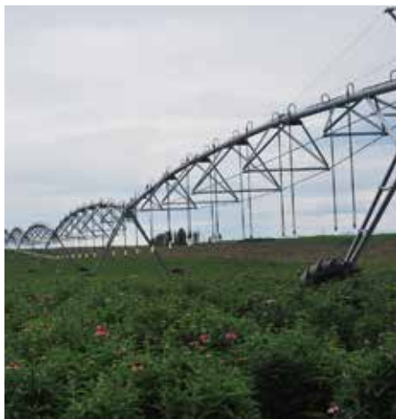
美国华盛顿州鲑鱼湖农场的埃弗拉塔分场，部署中央枢轴灌溉系统来灌溉农作物，2013 年。移动的喷头顺序实现最佳的配水，从而最大限度地加快作物的生长。
